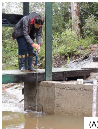
Figura 5 - Equipamento FlowTracker durante medições em campo (A). Sensor do equipamento dentro da água durante medição (B).
