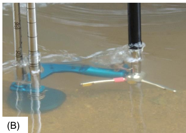
Figura 5 - Equipamento FlowTracker durante medições em campo (A). Sensor do equipamento dentro da água durante medição (B).
