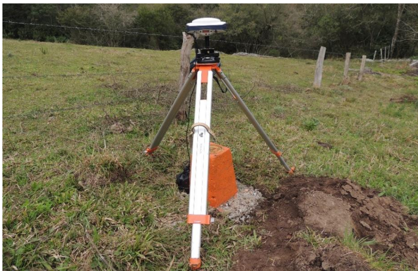
Figura 3 - Marco topográfico próximo ao exutório da bacia e receptor GPS Promark 500
