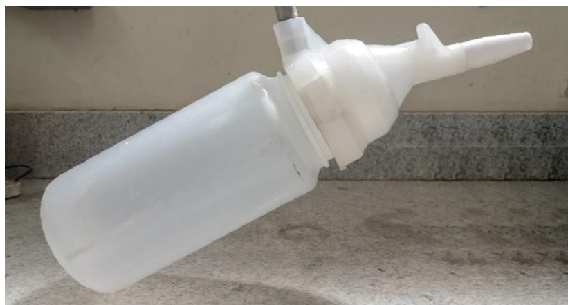
Figura 7 - Amostrador a vau SDH 81 para sedimento em suspensão.
