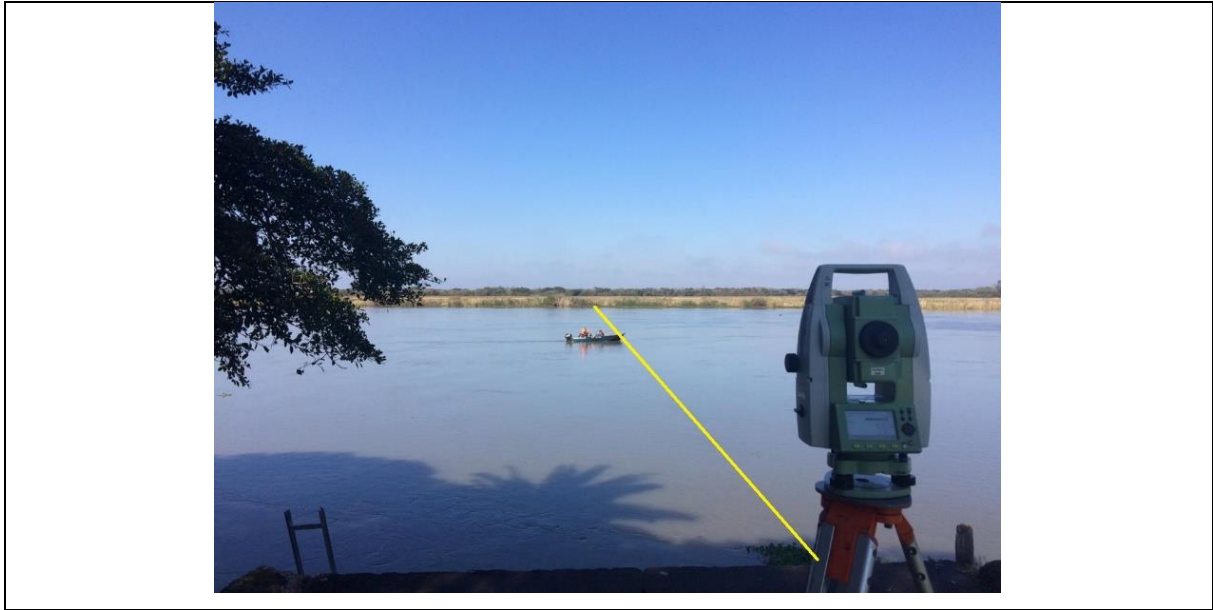
Figura 31 – Balizamento da embarcação durante processo de amostragem de sedimentos (Local: Seção 1). Fonte: Próprio autor.
