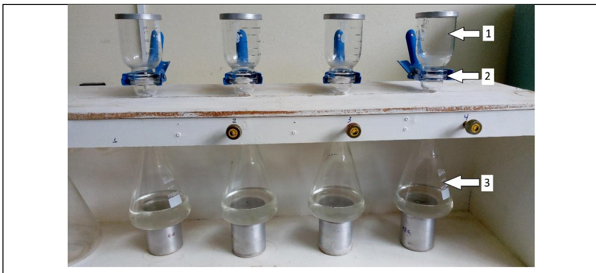
Figura 32 – Sistema montado para execução do método de filtração das amostras, contendo cada peça um cadinho de Gooch (1), uma membrana filtrante (2) e um Erlenmeyer (3). Fonte: Próprio autor.
