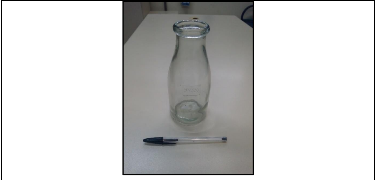
Figura 10 – Garrafa de 470ml utilizada em amostradores de sedimento em suspensão. Fonte: Próprio autor.
