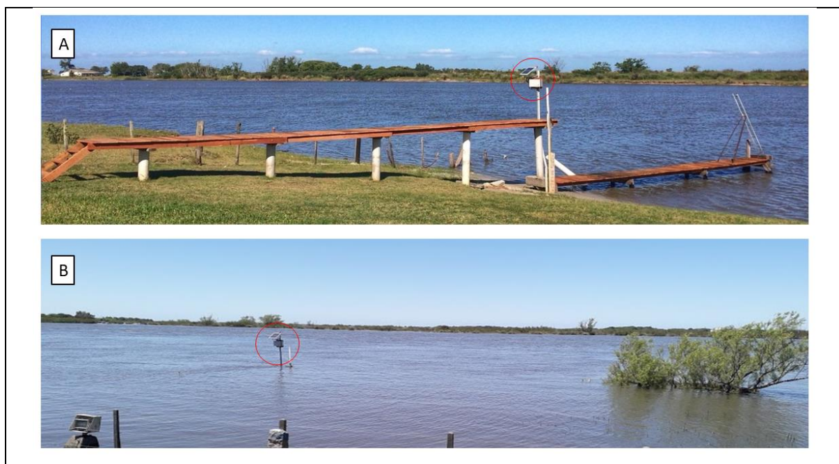
Figura 26 – Seção 2 localizada em Santa Isabel do Sul a) com vazões médias e b) com vazões máximas. Em destaque aparece o Data Logger e painel solar do LS-500 lá instalados (06/11/2019) Fonte: Próprio autor.
