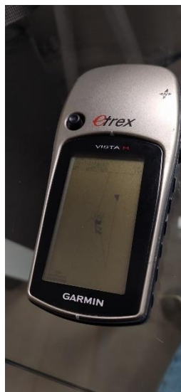
Figura 22. GPS Garmin modelo Etrex Vista H utilizado durante as campanhas amostrais. Fonte: Autora.
