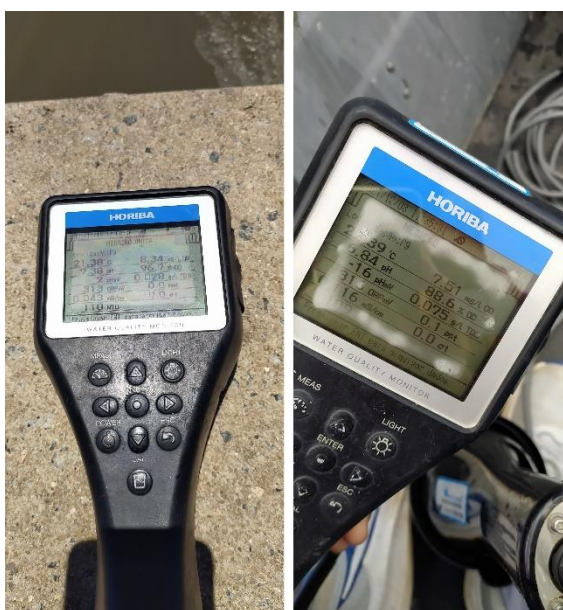
Figura 23. Sonda de qualidade de água multiparamétrica, modelo U-50, fabricante Horiba. Fonte: Autora.
