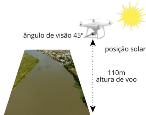
Figura 29. Esquema de captura das imagens aéreas. Fonte: Autora.
