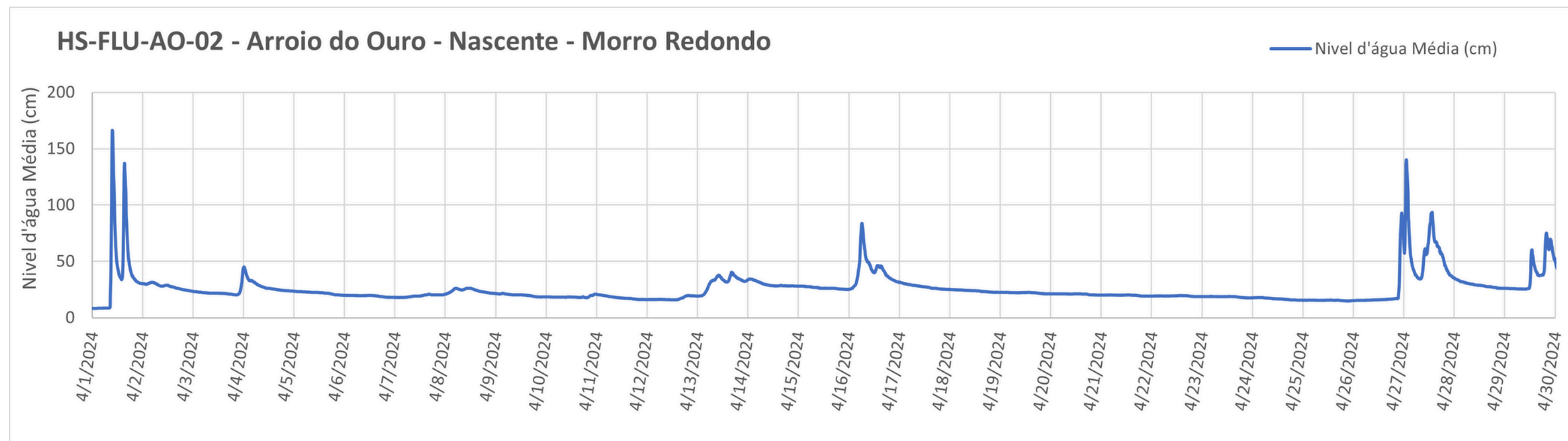
Figura 7 - Nível d'água médio (cm) na Estação o Arroio do Ouro (Nascente).
