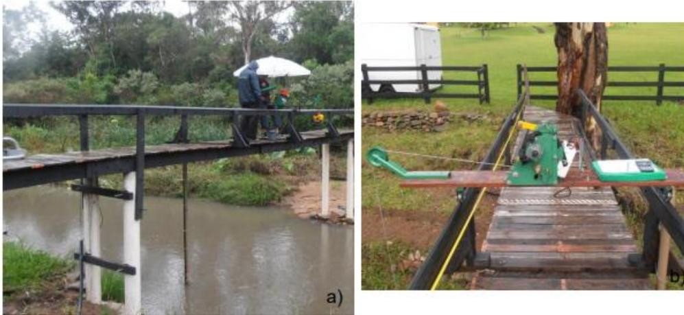
Figura 2 – Estrutura construída para realizar as medições de vazão, concentração de sedimentos em suspensão e sedimento transportado em arraste (a) e detalhe da instalação do guincho hidrométrico (b).
