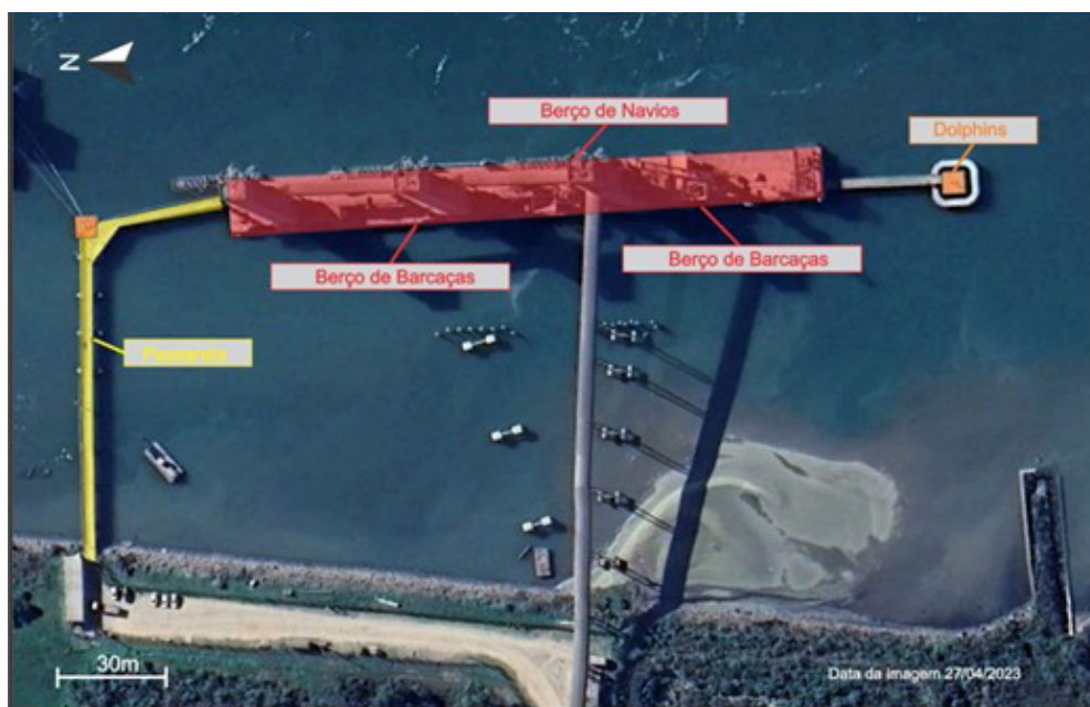
Figura 12: Configuração dos berços operacionais do Terbian.
