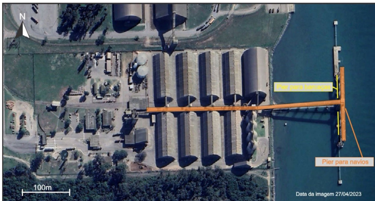
Figura 15: Correia transportadora do Termasa.
