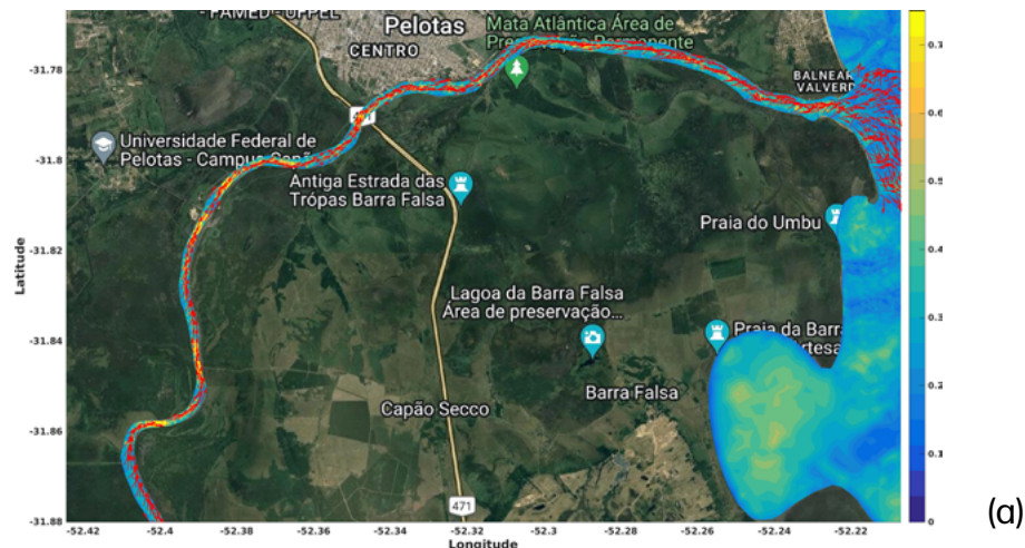
Figura 16: Parâmetros simulados na região do canal São Gonçalo próximo a cidade de Pelotas. (a) Velocidade residual direcional e velocidade máxima de fundo (m/s). (b) Máximo do atrito cisalhante de fundo ( N/m^2 ). (c) Transporte de sedimentos pelo fundo ( m^2/s ) e Evolução do fundo (m).
