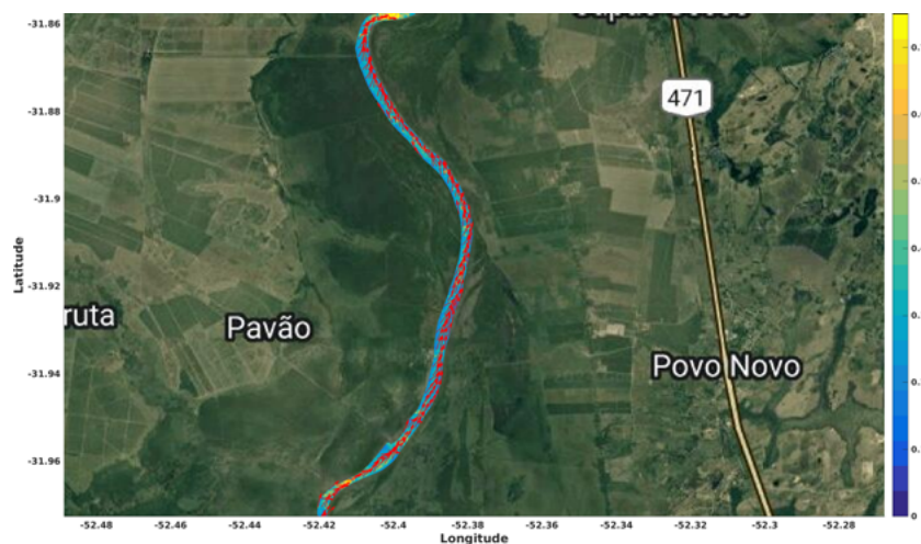
Figura 15: Parâmetros simulados na região do canal São Gonçalo. (a) Velocidade residual direcional e velocidade máxima de fundo (m/s). (b) Máximo do atrito cisalhante de fundo ( N/m^2 ). (c) Transporte de sedimentos pelo fundo ( m^2/s ) e Evolução do fundo (m).
