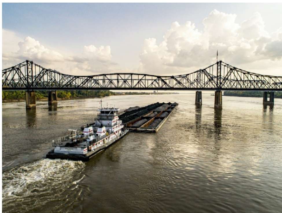
Figura 173: Embarcação-tipo Empurrador e Barca, transportando minério (WILKENS, 2020).
