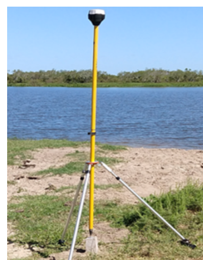
Figura 90.b - Monumentação e rastreamento do marco geodésico do futuro Porto do Tacuari.
