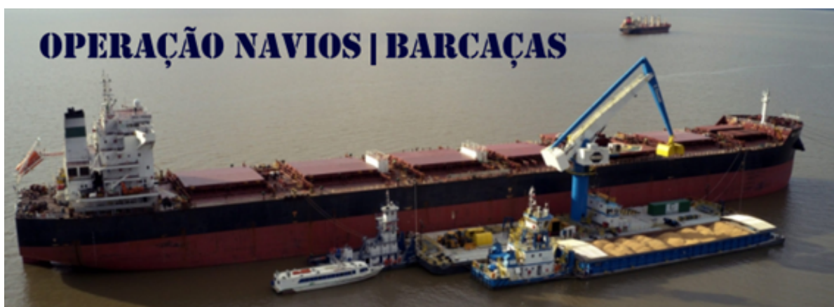
Figura 64: Modelo conceitual de estação de transbordo fluvial-marítimo (DTA, 2023).
