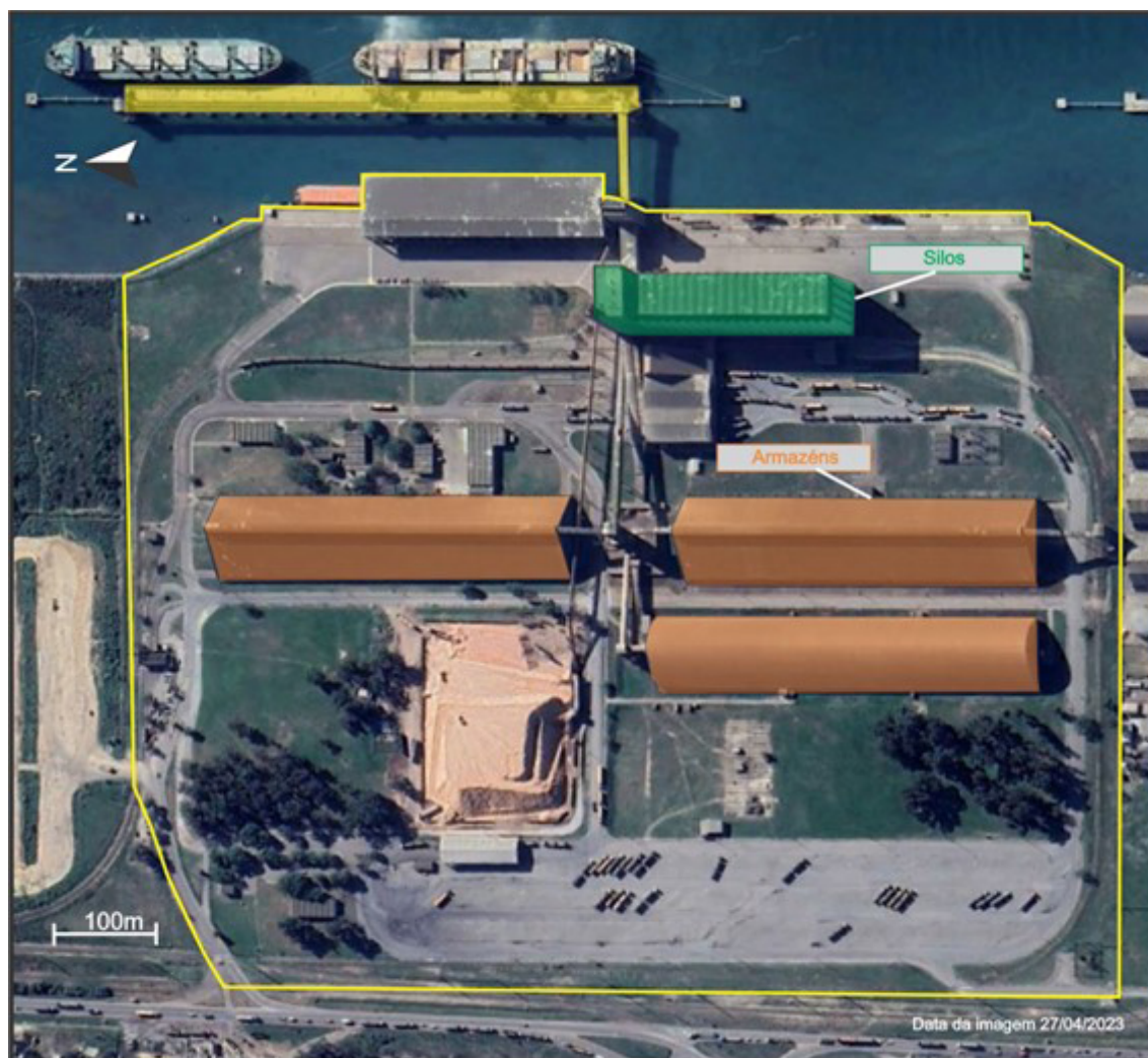
Figura 10: Configuração do Tergrasa.
